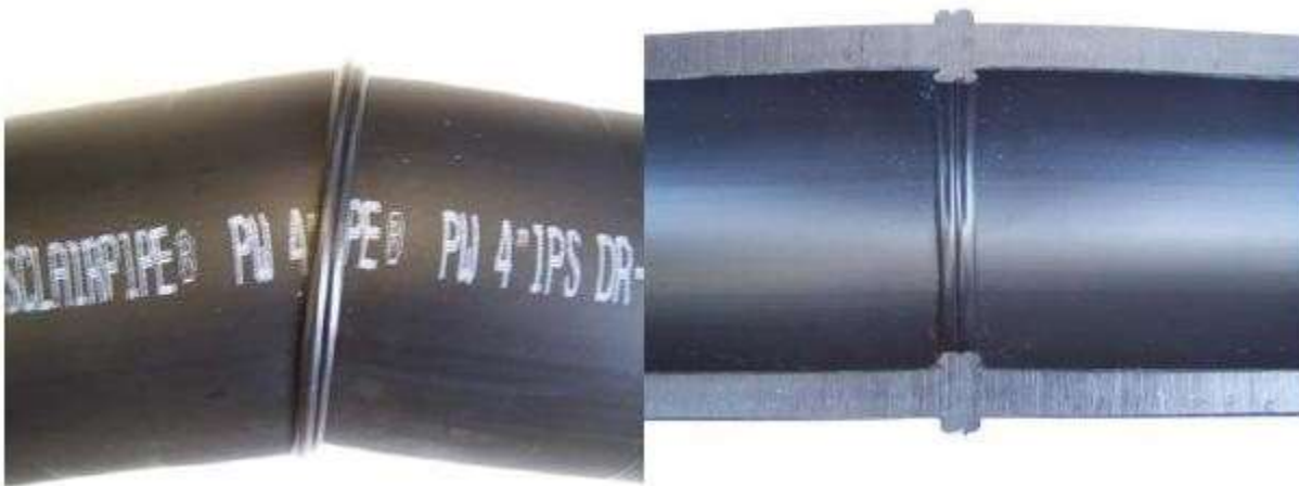
(e) Ống chưa được bào hoàn chỉnh hoặc chưa làm sạch hết phoi bào
