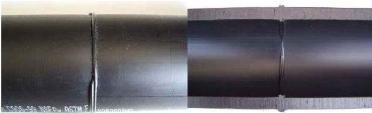
(d) Vết ghép bị chéo (ống bị gá lệch trong máy hàn)
